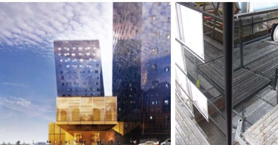
**L'INCLINAZIONE DELLE FACCIATE, UNITA ALLA VOLONTÀ DI NON FAR PERCEPIRE DALL'ESTERNO IL TELAIO DEI SERRAMENTI, HA DATO LUOGO A UNA SOLUZIONE DI PARETE VENTILATA E IN GRADO DI RACCOGLIERE AL PROPRIO INTERNO L'ACQUA E DI POTERLA CONDURRE A TERRA ATTRAVERSO SPECIALI CANALIZZAZIONI INSERITE NELL'INTERCAPEDINE.**
